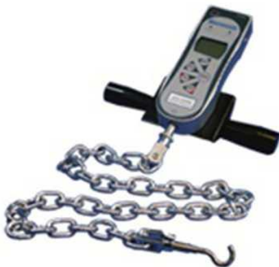
Imágenes 1 y 2. Dinamómetro y utilización del dinamómetro
